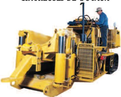
Les cintreuses hydrauliques de tubes Darby sont les plus perfectionnées sur le marché d'aujourd'hui. Tous les éléments structurels sont fabriqués en acier T-1 haute résistance et sont standard sur tous les moteurs diesel Caterpillar Tier III et les compresseurs d'air Quincy.
